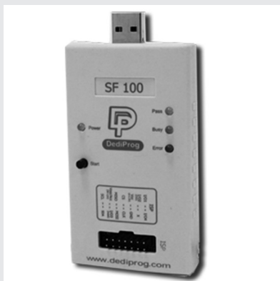
Rysunek 19.8. Programator Dediprog SF100 ISP IC
