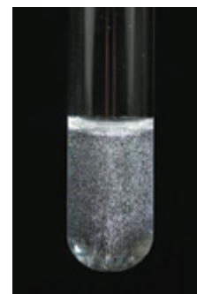
Reakcja między cynkiem a rozcieńczonym kwasem chlorowodorowym stosowana jest do wytwarzania wodoru. Źródło ilustracji: University of Bath
