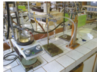
Laboratoryjny aparat do destylacji próżniowej. Ilustracja dzięki Izmaelt/CC BY-SA 3.0
