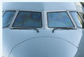
▲ Cienkie warstwy przewodzące ITO na powierzchni szkła służą do odszraniania przednich szyb samolotów. Źródło obrazu: aSuruwataRi/Shutterstock.com
