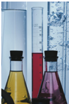
Szko laboratoryjne jest zwykle wykonane ze szkła borokrzemowego, takiego jak Pyrex™, ponieważ nie rozszerza się ono zbyt mocno pod wpływem ogrzewania lub chłodzenia. Źródło obrazu: PhotoDisc
