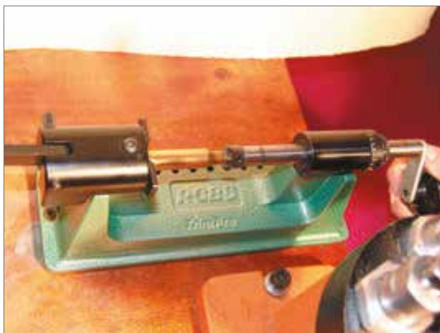
Rys. 10.1. Trymowanie długości łuski za pomocą przyrządu z napędem ręcznym
