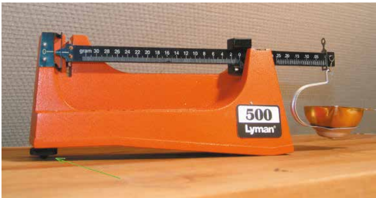
Rys. 13.1. Zerowanie wagi szalkowej; strzałka wskazuje śrubę regulacyjną
