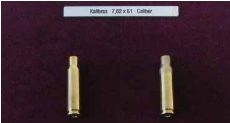
Rys. 2.6. Obróbka cieplna szyjki łuski – wyżarzanie [zdjęcie publikowane za zgodą firmy GGG]
