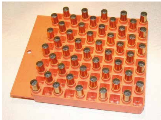
Rys. 13.6. Wizualne sprawdzanie poziomu prochu w łuskach
