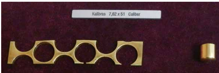
Rys. 2.2. Etapy produkcji łusek karabinowych – wycinanie i wstępne tłoczenie [zdjęcie publikowane za zgodą firmy GGG]
