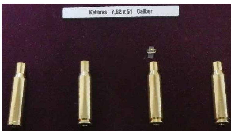
Rys. 2.5. Etapy produkcji łusek karabinowych – ostateczne kształtowanie kieszonki na splonkę, toczenie wlotku oraz przycinanie łuski na długości wraz z załamywaniem krawędzi [zdjęcie publikowane za zgodą firmy GGG]
