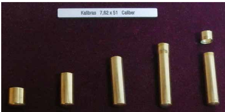
Rys. 2.3. Etapy produkcji łusek karabinowych – wyciąganie ścianek bocznych za pomocą następujących po sobie operacji wytłaczania [zdjęcie publikowane za zgodą firmy GGG]
