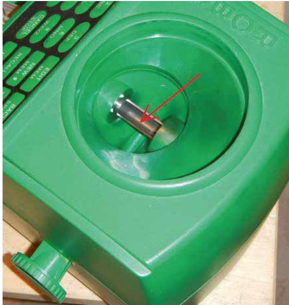
Rys. 13.3. Wnętrze zasobnika na proch. Strzałka wskazuje rurkę transportową, którą należy ustawić tak, aby otwór znajdował się w dolnym położeniu i przez pochylenie urządzenia wyspać proch, który w niej pozostał
