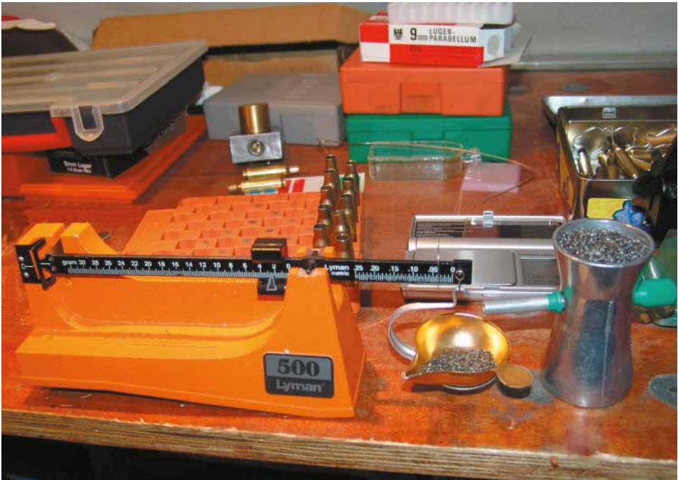
Rys. 13.5. Dozowanie prochu metodą wagową
