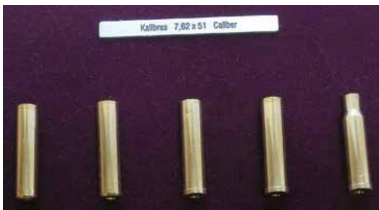
Rys. 2.4. Etapy produkcji łusek karabinowych – kształtowanie kieszonki na splonkę, kryzy i szyjki łuski [zdjęcie publikowane za zgodą firmy GGG]
