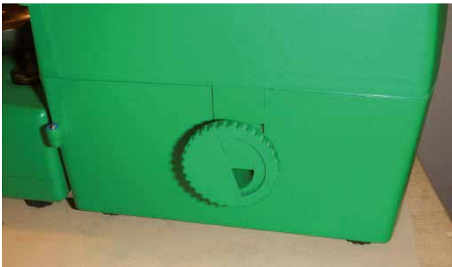
Rys. 13.4. Zawór do usuwania prochu z zasobnika
